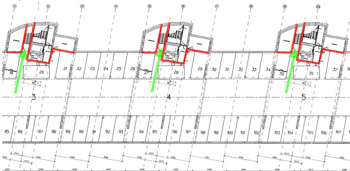
Figuur 1 Principe stallingsgarage met brandwerende scheidingsconstructies naar woontorens (rood) en vluchtroutes vanuit de garage (groene pijlen).
