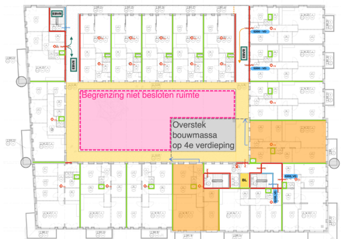
Figuur 1 Principeplattegrond 1 e , 2 e en 3 e verdieping met de als niet besloten galerij aangemerkte extra beschermde vluchtroute (geel), de open ruimte met begrenzingen van de niet besloten ruimte (roze) en het overstek van de bouwmassa op de 4 e verdieping (grijs).
